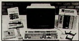
Ontwikkelstation rond een PC om (her)programmeerbare poortschakelingen te kunnen toepassen in elektronica besturingen.
